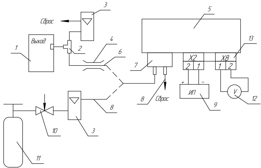
а) для сигнализаторов СТГ-3-Н<sub>2</sub>S, СТГ-3-SO<sub>2</sub>, СТГ-3-Cl<sub>2</sub>, СТГ-3-NO<sub>2</sub>, СТГ-3-HCl с коробкой соединительной;
