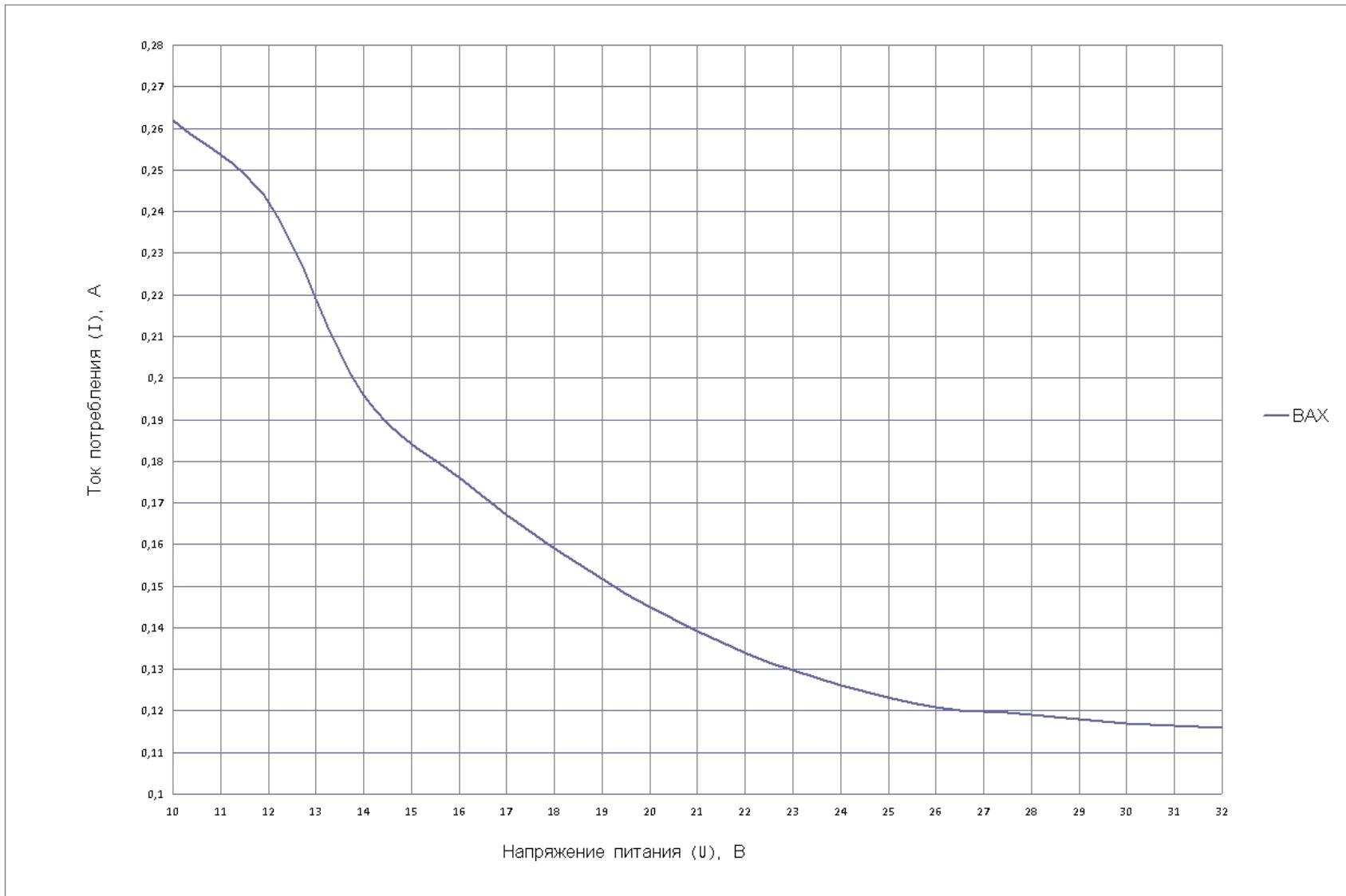
Рисунок Ж.5 – Зависимость тока потребления сигнализаторов СТГ-3-Ex, СТГ-3-И-Ex
