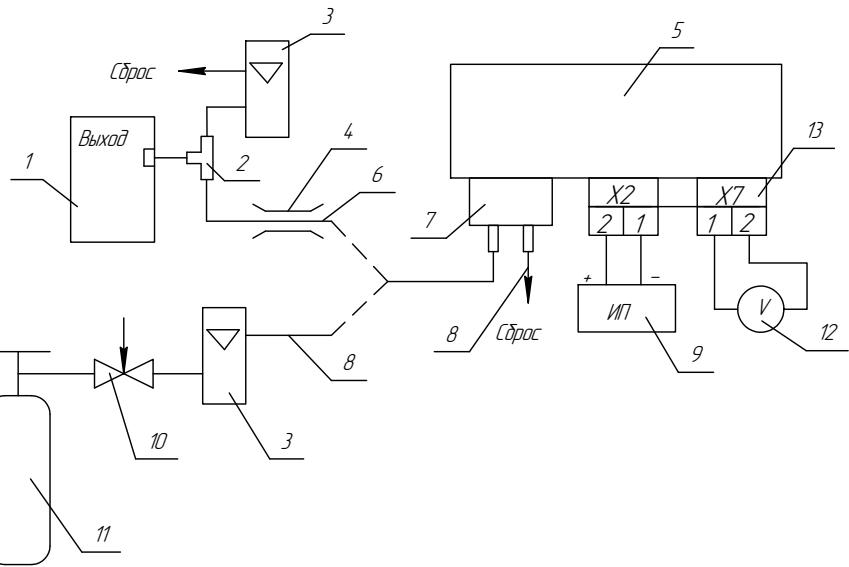
б) для сигнализаторов СТГ-3-И-Н<sub>2</sub>S, СТГ-3-И-SO<sub>2</sub>, СТГ-3-И-Cl<sub>2</sub>, СТГ-3-И-NO<sub>2</sub>, СТГ-3-И-HCl с коробкой соединительной
