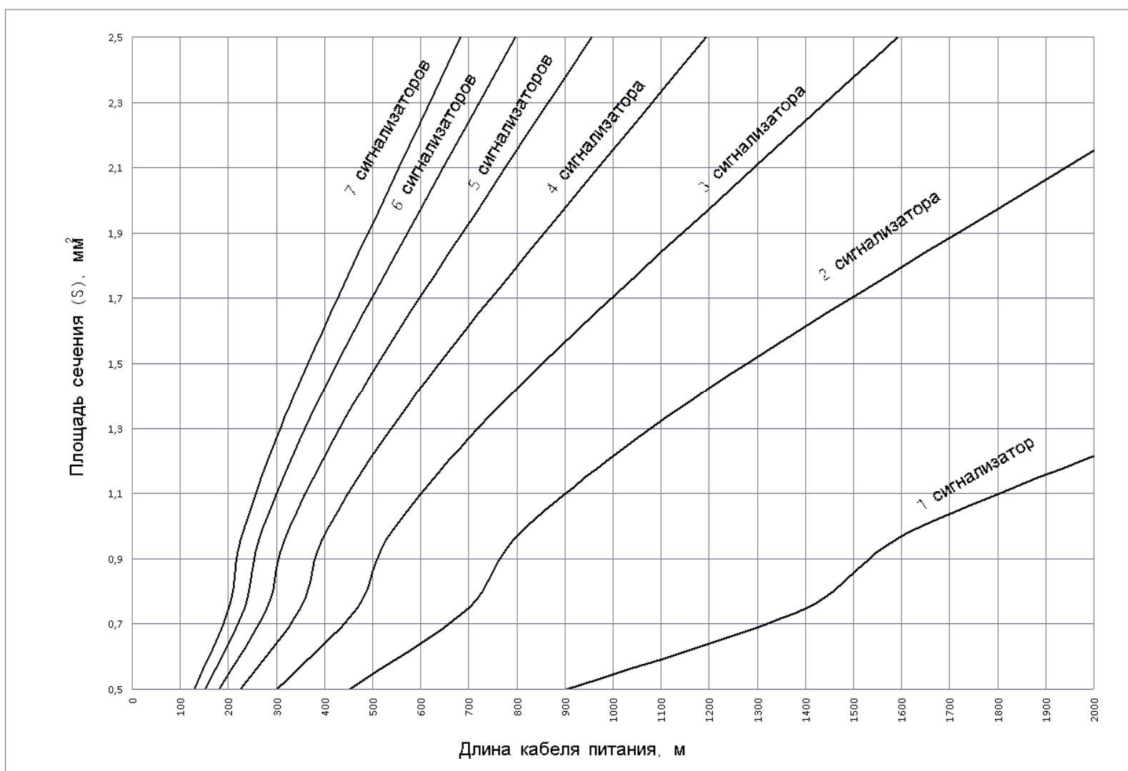
Рисунок Ж.2 – Зависимость сечения жил кабеля от длины кабеля при сосредоточенном расположении
