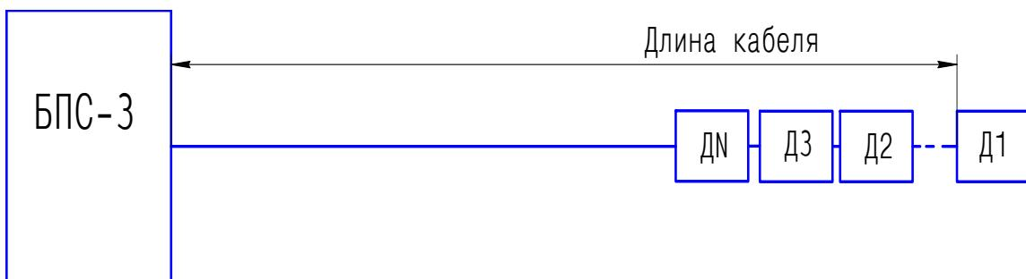
Рисунок Ж. 1 – Пример сосредоточенного расположения сигнализаторов
