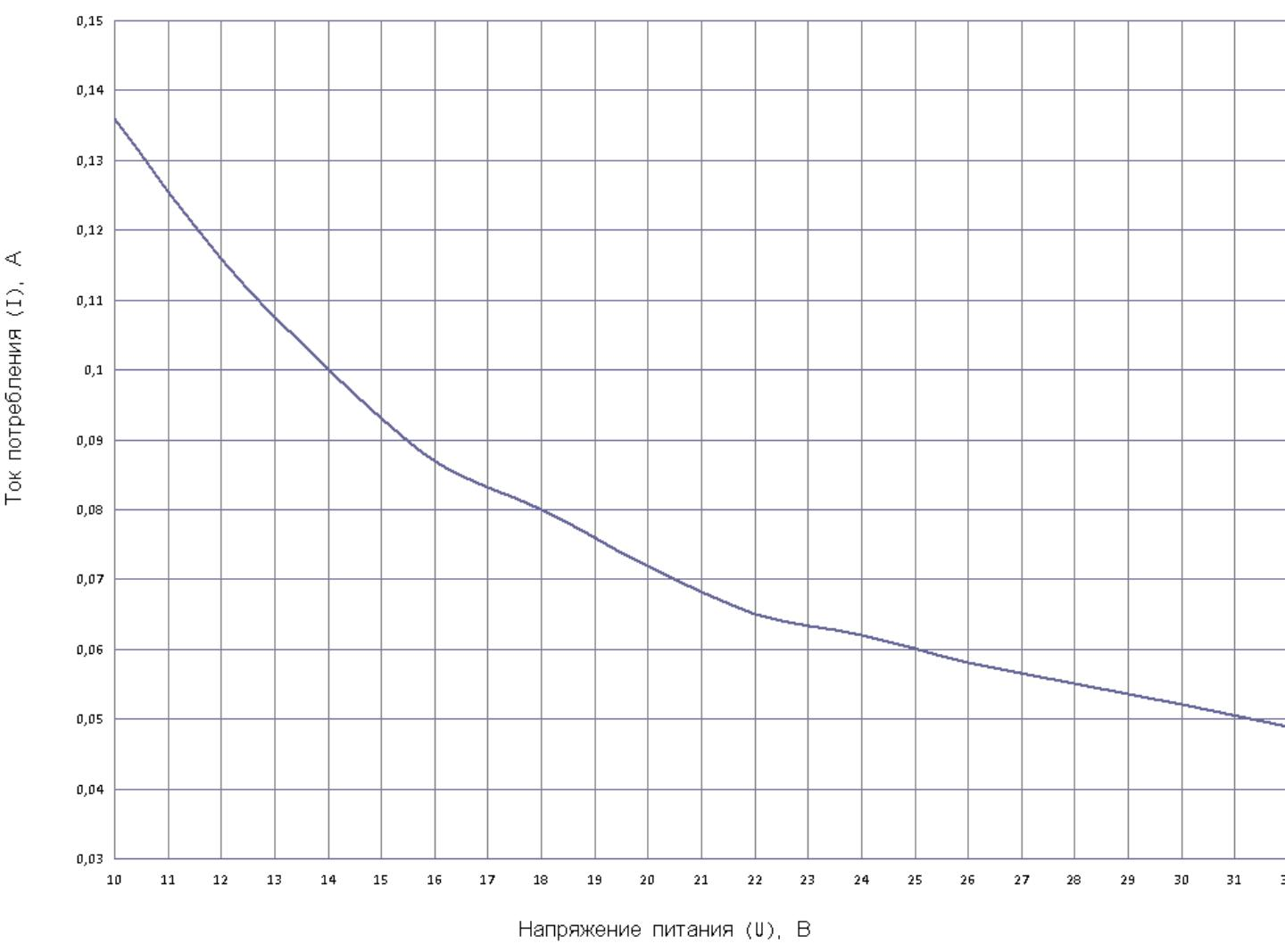
Рисунок Ж.6 – Зависимость тока потребления сигнализаторов СТГ-3-ХХ, СТГ-3-И-ХХ
