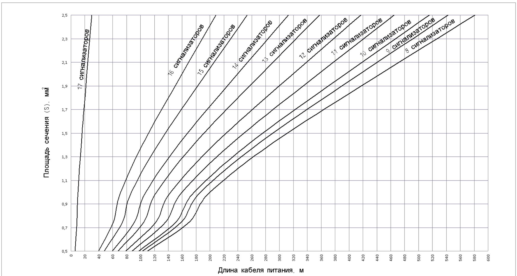
Рисунок Ж.3 – Зависимость сечения жил кабеля от длины кабеля при сосредоточенном расположении
